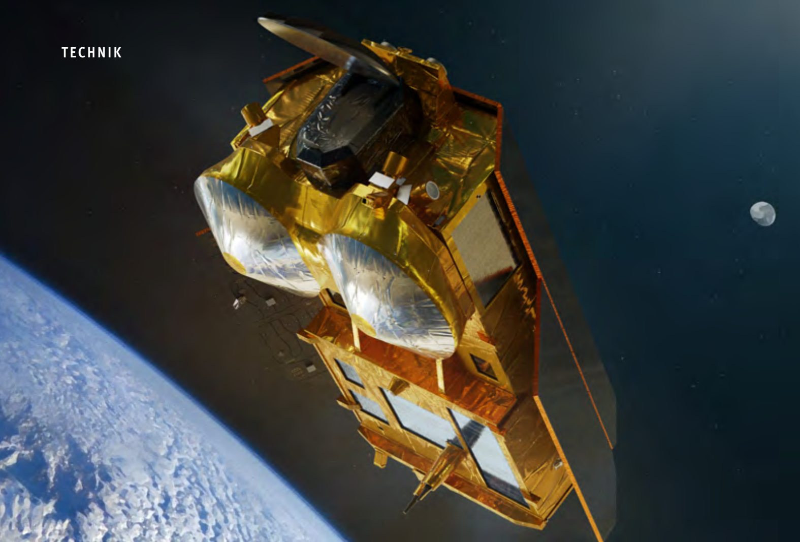
So wird der Satellit CRISTAL aussehen, der ab 2028 Meereisdicke, Schnee- und Eisschildhöhe an den Polen messen soll.
